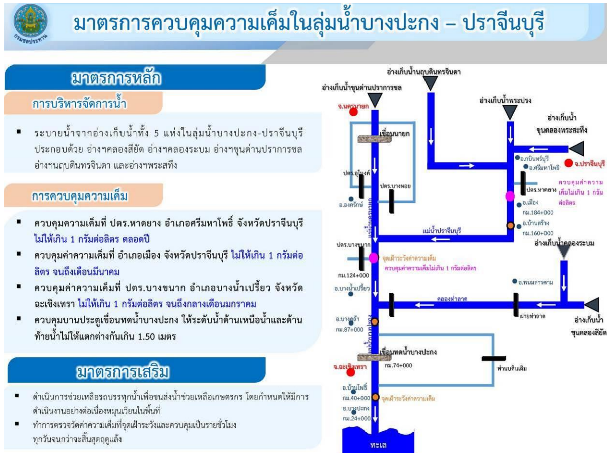
รูปที่ 71 มาตรการควบคุมความเค็มในแม่น้ำบางปะกง – ปราจีนบุรี
